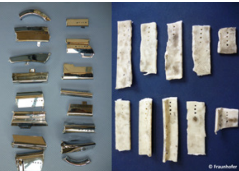
Verchromte Zierleisten vor und nach der elektrohydraulischen Zerkleinerung
