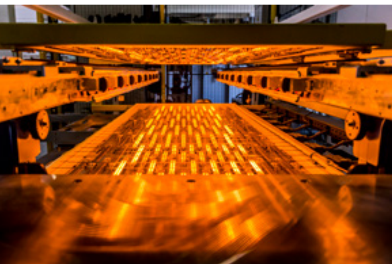
Infrarot-Systeme von Heraeus Noblelight sparen Energie und Zeit bei der Fertigung von Auto-Innenverkleidungen.
